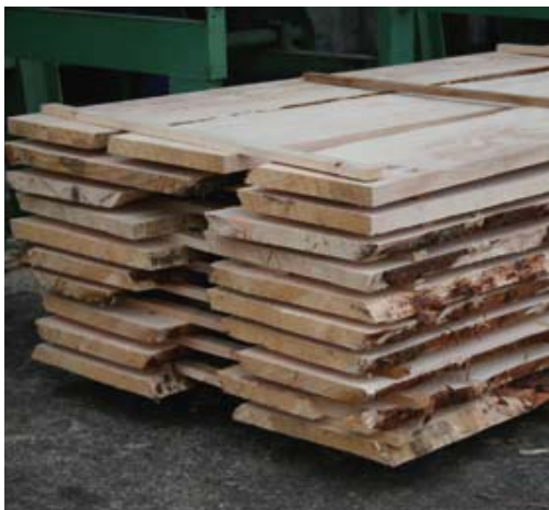
Filetiert: Beim Einschnitt in Chanovice werden Waldkanten bewusst akzeptiert – selbst Waldkantenlatten werden bis zum letzten Kubikzentimeter verwertet
