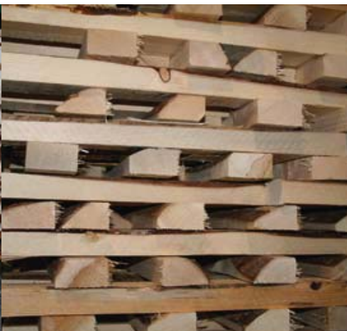
Filetiert: Beim Einschnitt in Chanovice werden Waldkanten bewusst akzeptiert – selbst Waldkantenlatten werden bis zum letzten Kubikzentimeter verwertet
